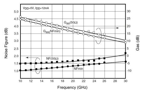
NOISE FIGURE & G<sub>as</sub> vs. FREQUENCY
